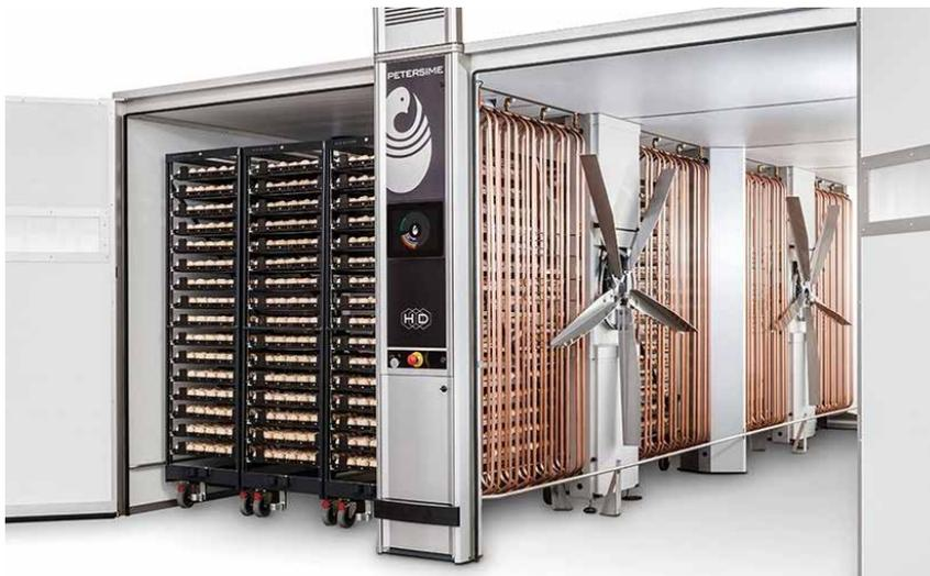
Blick in einen geöffneten, modernen Vorbrutschrank. Im Bild ist die linke Seite mit Hordenwagen voll belegt, die rechte Seite ist noch leer. Die Installationen für die Heizung, Kühlung, Befeuchtung und Luftzirkulation können unterschiedlich angeordnet sein (siehe Bild unten; Details siehe Bild rechts).
