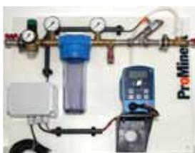
wickelt. Die Genauigkeit ist auch bei kleinem Wasserverbrauch gegeben. Die Anlage ist vorkonfiguriert, kostengünstig und anschlussfertig. Das Herzstück: Eine Magnet-Membrandosierpumpe mit einem Leistungsbereich bis 32 l/h, montiert auf einer Wandkonsole mit einem Durchflussmesser mit zwei analogen Ausgängen – für die Dosierpumpe und für den Futtercomputer.
