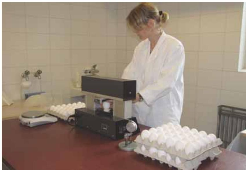
**Bild:** Bestimmung der Schalenbruchfestigkeit im Rahmen der Legeversuche am Aviforum.
