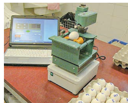
Für züchterische und wissenschaftliche Zwecke wird die Stabilität der Eischale mit solchen speziellen Geräten erhoben. Sie messen die Bruchfestigkeit unter zunehmendem Druck (Bild oben) oder das Schwingungsverhalten bei mechanischem «Abklopfen» der Schale (Bild unten). Letzteres wird auch bei sogenannten Crack-Detektoren ausgenutzt, die bei grossen Sortieranlagen automatisch Knickeier erkennen und aussortieren.
