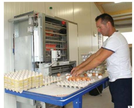
Die Eier werden hier von den mehrstöckigen Nestern via Sammelbänder in den Stallvorraum transportiert und mit Elevatoren auf einer Sammelfläche abgelegt.
