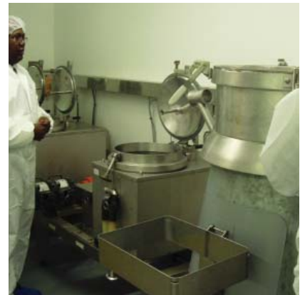
Bild 2: Flotationsbehälter und Zentrifugen
