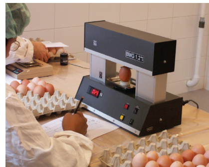
Bild: Das Bruchfestigkeits-Messgerät, das im Versuch zum Einsatz kam.
