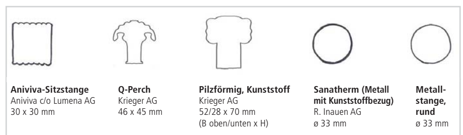
Abb. 1: Schematische Darstellung der in der praktischen Prüfung verwendeten Sitzstangen. Die Aniviva-Sitzstange und die Q-Perch wurden neu zur Bewilligung eingereicht. Die anderen drei Stangen werden schon seit Jahren für die Legehennenhaltung in der Schweiz verwendet.
