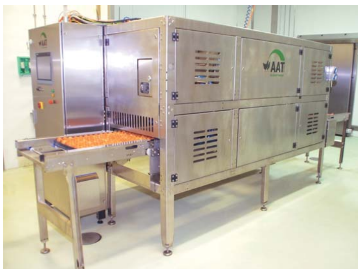
↑ Abb. 3: Schematischer Aufbau der Hyperspektralanalyse («Embryonales Farbsexing») bei Braunlegern am 13. Bruttag. Quelle: AAT
