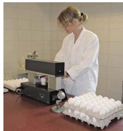
La solidité de la coquille d'œuf est mesurée avec ce genre d'appareils spéciaux à des fins zootechniques et scientifiques. Ils mesurent la résistance à la casse des œufs soumis à une pression croissante ou la manière dont les œufs oscillent lorsqu'on «tape» mécaniquement la coquille. On utilise aussi ce dernier critère avec les détecteurs de fissures (cracks) qui identifient et séparent automatiquement les œufs fêlés dans les grandes installations de tri.
