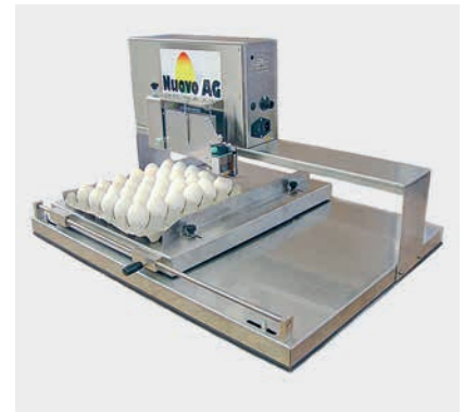
Machine à estampiller les œufs (estampillage CH, date de ponte, etc.).
