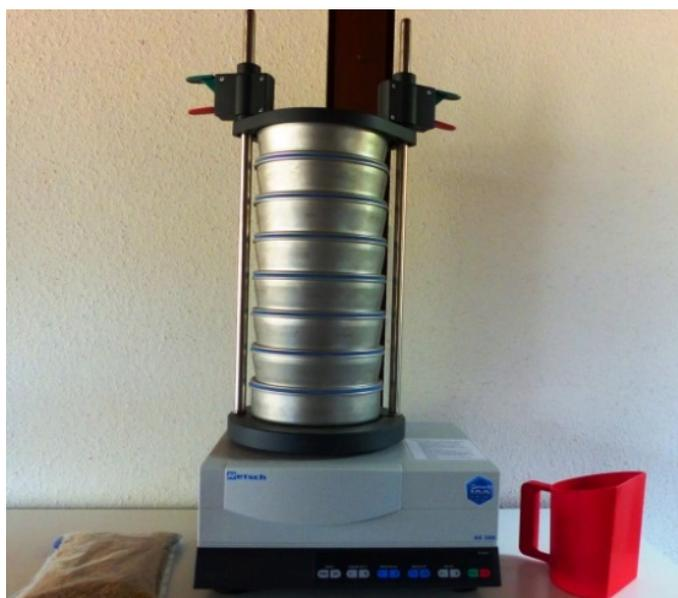
Abb. 17: Siebanalysegerät zur Bestimmung der Futterstruktur
